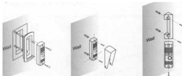
(1) врезная установка      (2) накладная установка      (3) накладная с наклоном
