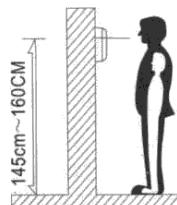
Оптимальная высота установки монитора составляет 145-160 см от центра экрана монитора до земли (эти данные консультационные и не более)
